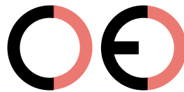
Virheellinen CE-merkki (liian kaukana)
